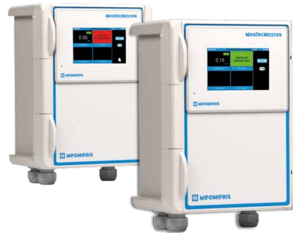
NeoTecMaster® - 5 Zoll im Gehäuse IP 66 als 4 Kanalsystem, vorkonfiguriert zur Aufnahme von bis zu 8 eingehenden 4-20 mA Signalen, einem R232 Signal sowie Modbus Signal, optional freischaltbar auf 8 Kanäle
